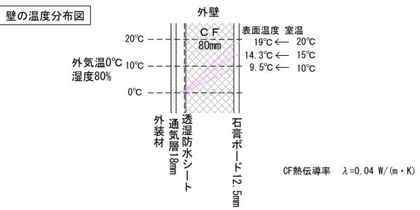
Fact-2 水蒸気の移動を妨げるものがないので、壁の内部でも結露しません
